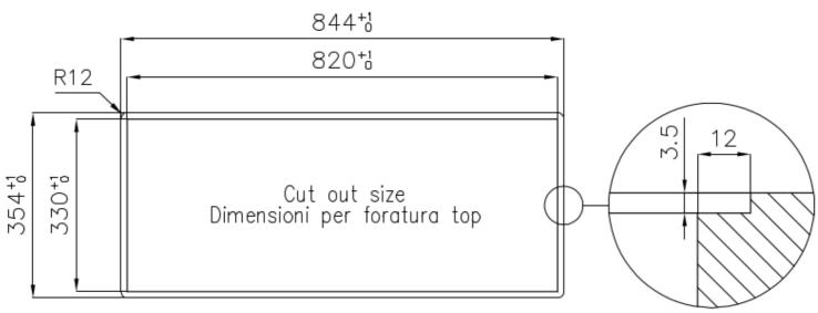
Built—in cut out for FTS: Foratura per installazione FTS: 810 x 330
